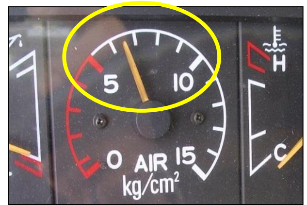
氣壓錶正常壓力 (約6~10 kg/cm 2 )
